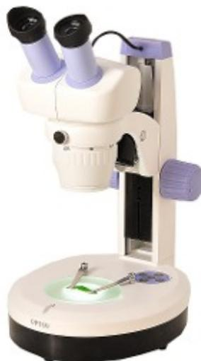
A lupa é utilizada constantemente para materiais muito grandes ou muito opacos para serem observados ao microscópio. É utilizada ainda na preparação de material para
