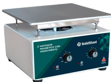
O Agitador Magnético foi desenvolvido para agitação de substâncias de baixa viscosidade, aquecimento de diversas substâncias através de sua plataforma aquecedora.
